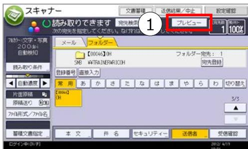
①宛先選択後、タッチパネル上部にある【プレビュー】を押して反転させてから【スタート】を押します。それ以外の操作は全く同じです。
