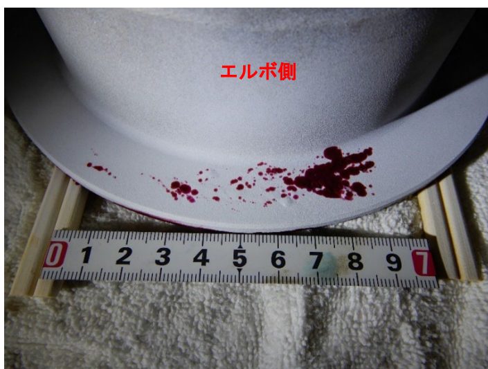
【写真 11】応力腐食割れの指示模様出
