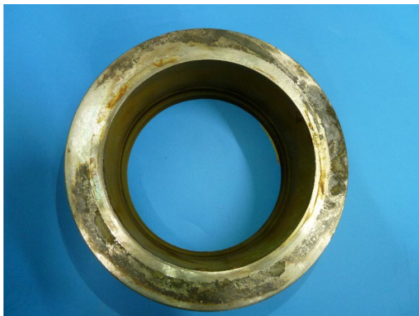
【写真4】エルボ側フランジ ブラスト前
