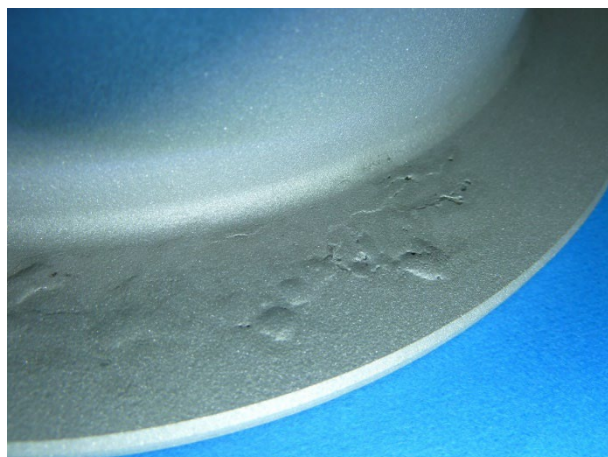
【写真6】エルボ側フランジ ブラスト後 内面 著しい腐食が発生している 配管内面に腐食の発錆は見られない
