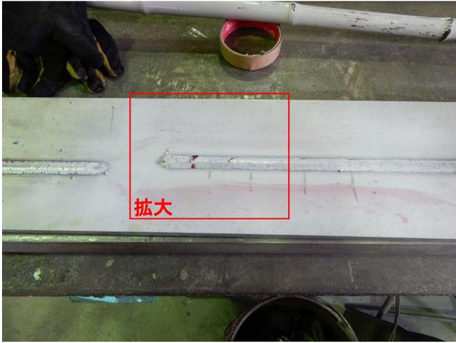
溶接後 P T 実施 位置がずれ右 2 箇所は割れなし
