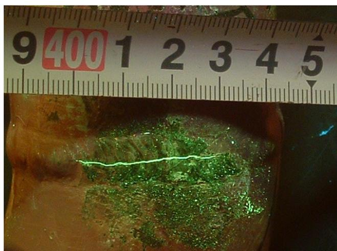
写真は漏洩している蒸気管溶接部である。目視による写真では注意しないと気付かない漏洩部であるが、磁粉探傷試験による写真では漏洩部が溶接部中央に発生した縦割れであることが容易にわかる。
