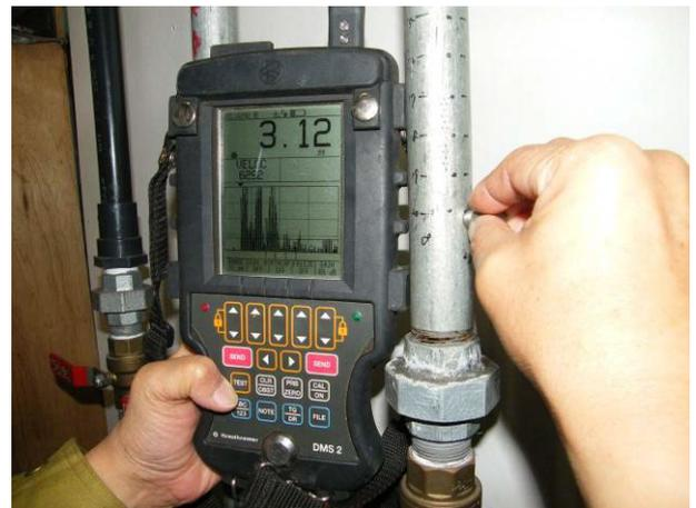
超音波厚さ測定は測定自体非常に簡単なものであり、あらかじめ決定しておいた測定点に対し前処理（塗装の除去、簡単な研磨）をおこない接触媒質（グリセリンなど）を塗布し、超音波の送受信をおこなう探触子（プローブ）を当てるだけで数値が表示される。この測定で重要なことは厚さ計の校正である。最近の厚さ計は厚さ計本体と探触子を接続しただけで自動校正をおこない測定できるものもあるが、探触子の片減りなどが原因で校正が不正確になってしまう場合がある。測定に際しては、必ず
