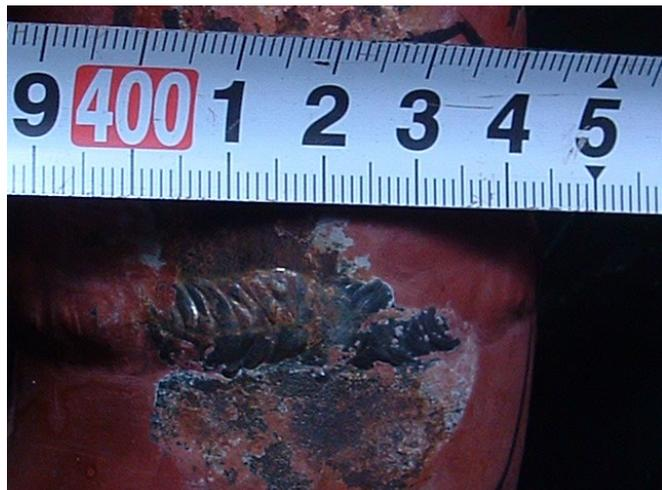
写真5-2 蒸気管溶接部発生した割れ（磁粉模様）
