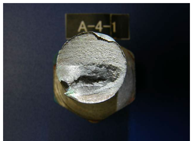
（ボルト側破断面）
