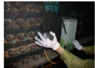
③清掃後、超音波ボルト軸力計にて計測を実施
