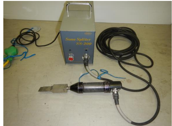
超音波振動塗膜剥離マシン(ソノスプリッターSS-200)
