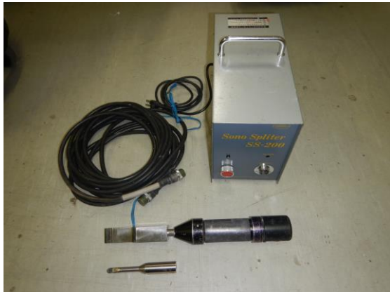
超音波振動塗膜剥離マシン(ソノスプリッターSS-200)
