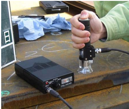
鋼材識別状況
