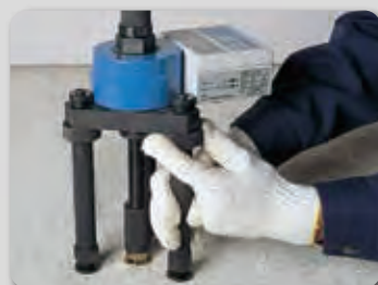
③ 床面の凹凸に合わせて脚の高さを調節
