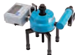
RT-3000LDII 最大荷重:30kN
