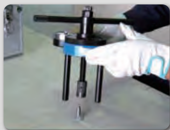
① カップリングをセンターシャフトにねじ込む
