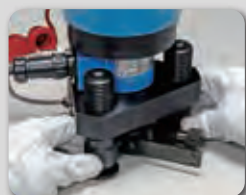
⑤ 3本の脚が試験面に均等に接するように調節
