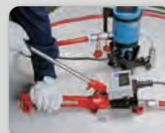
⑦ 油圧ポンプのレバーに力を加えながら測定
