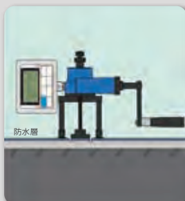
屋上防水層下地の引張荷重確認
