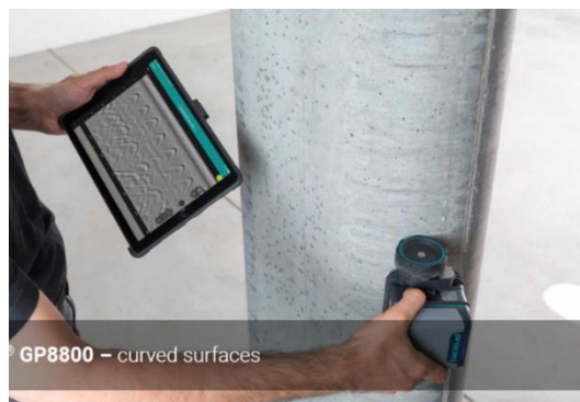
写真③-円柱形状でも探査可能
