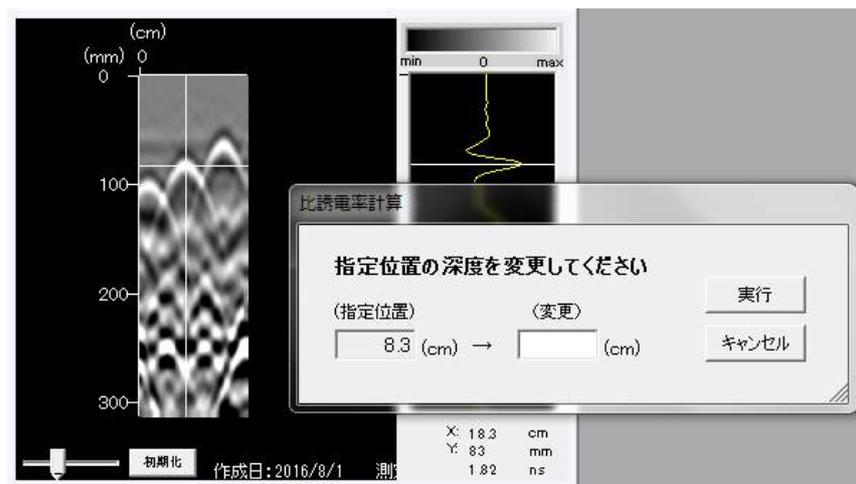
図5.3-7 比誘電率計算ダイアログ
