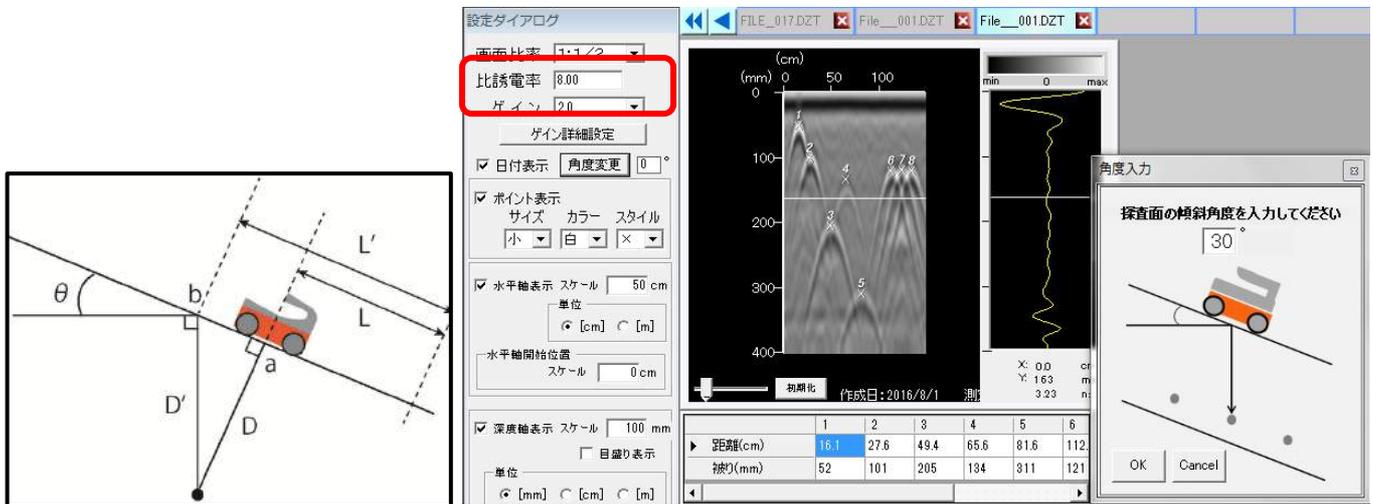
図5.1-12 傾斜角度変更画面
